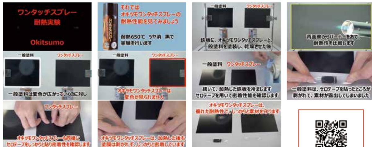
オキツモのワンタッチスプレーの耐熱実験を行いました。ガスバーナーで加熱しても剥がれにくい、優れた耐熱性をご確認ください。エアゾールタイプなので手軽に塗装ができ、オートバイのプレーキキャリパーやディスクブレーキ等の補修にも活用できます。
