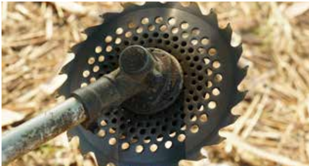
草刈り機 塗装箇所 実績塗料 マフラー 四輪マフラー用塗料（MF4-B） チップソー 潤滑塗料（NTB3202・NTB3101）
